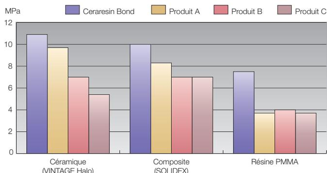
Résistance à l'adhésivité de **Ceraresin Bond** dans la liaison composite / céramique face à d'autres fabricants.
