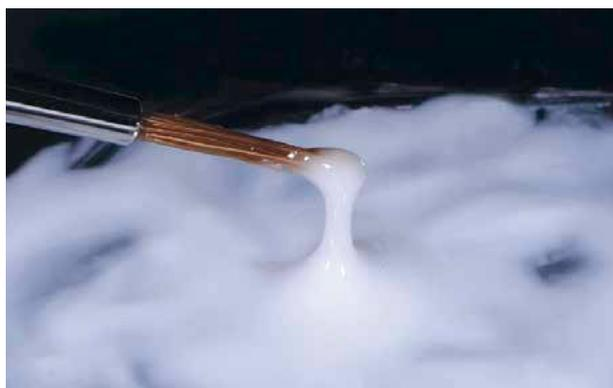
Lorsqu'on mélange la poudre de glaçage au Vintage Art Universal Liquid ou à d'autres liquides du même type, l'émail prend une apparence laiteuse et blanchâtre. L'effet et la translucidité n'apparaîtront qu'après cuisson sous vide.
