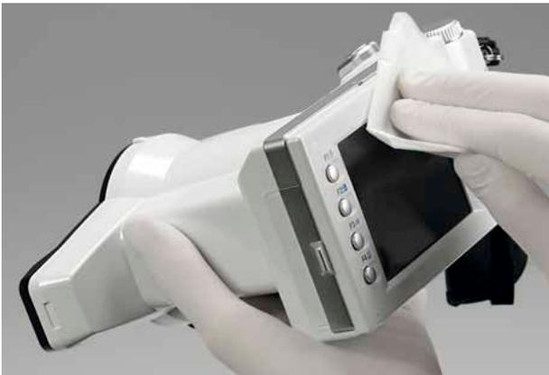
L'appareil peut être nettoyé et désinfecté à l'éthanol.
