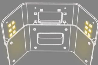
LEDs latérales allumées à pleine puissance + diffuseur, LEDs centrales éteintes
