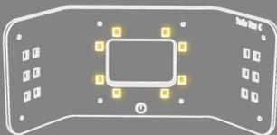
LEDs centrales allumées à pleine puissance, LEDs latérales éteintes
