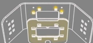
LEDs centrales allumées à pleine puissance + filtre polarisant, LEDs latérales éteintes
